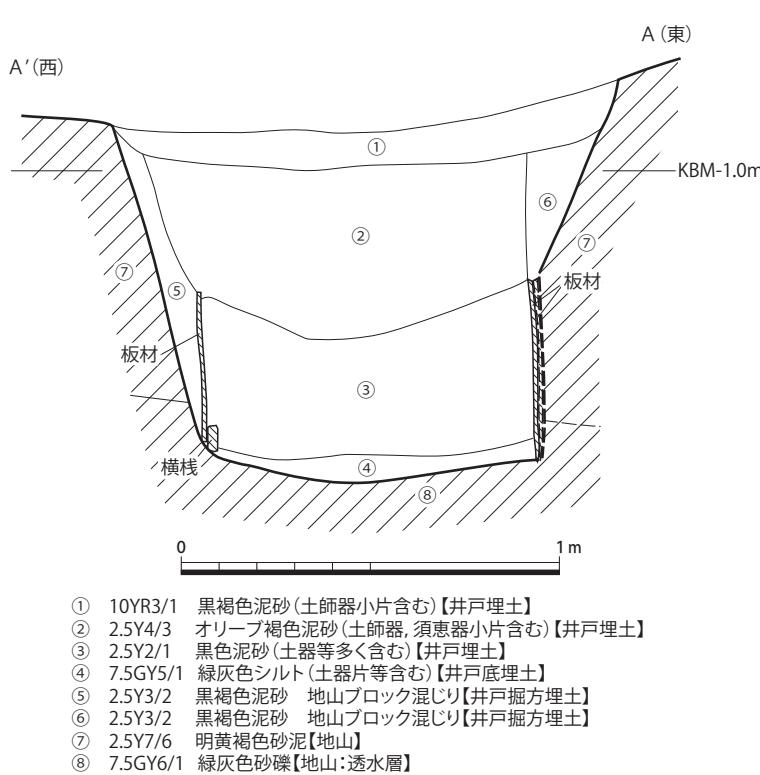
図44 14区平面図・断面図・立面図（1：60）
