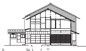
図 40 竹中庵主屋 断面図 (1:350)
