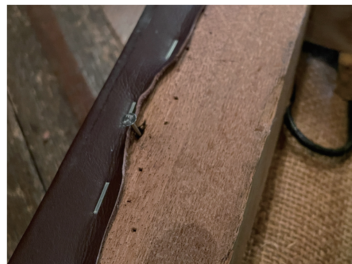
図2 タッカーで固定された座面の皮
