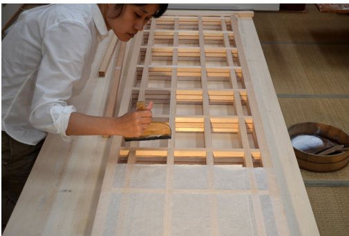
図15 骨縛り（組子下地に裏打紙を貼る）
